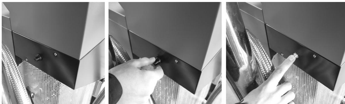
Рис. 17: Включение термического предохранителя
